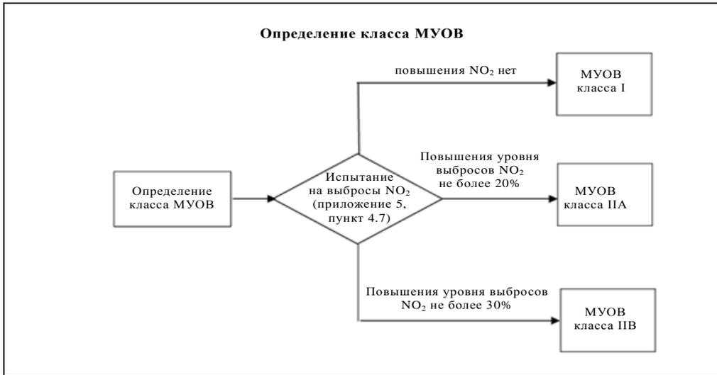
2. Последовательность испытания МУОВ для ограничения выбросов NO<sub>x</sub>
