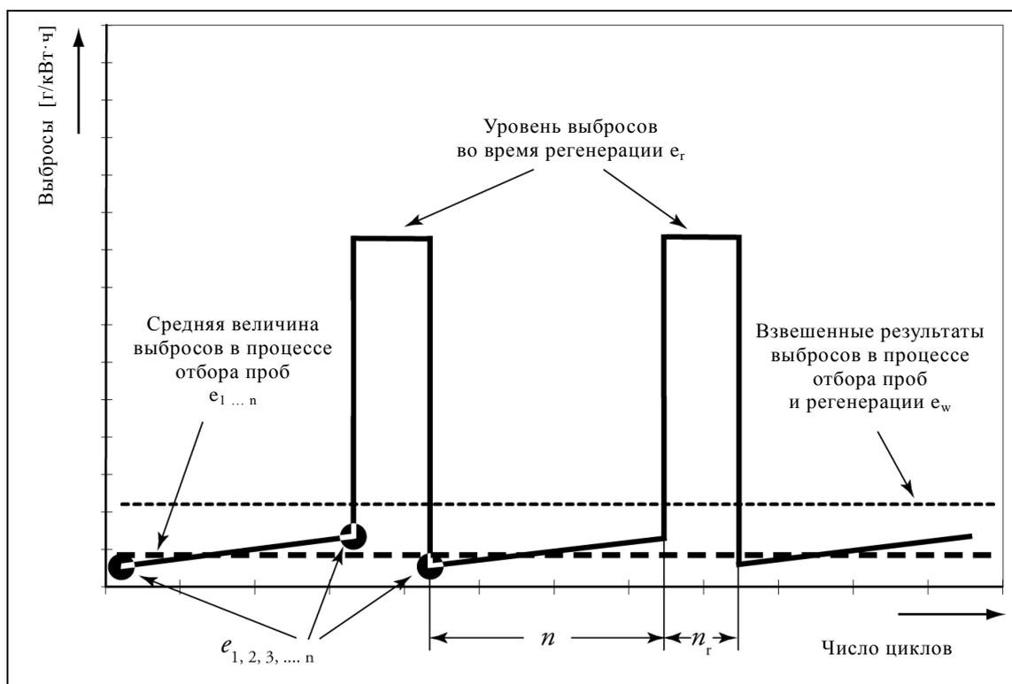
Считается, что испытание системы МУОВ с периодической регенерацией для ограничения выбросов взвешенных частиц было пройдено успешно, если номинальный уровень выбросов твердых частиц, рассчитанный с использованием описанной ниже процедуры, соответствует предельным значениям для того уровня снижения выбросов, по которому заявитель желает получить официальное утверждение для МУОВ.
