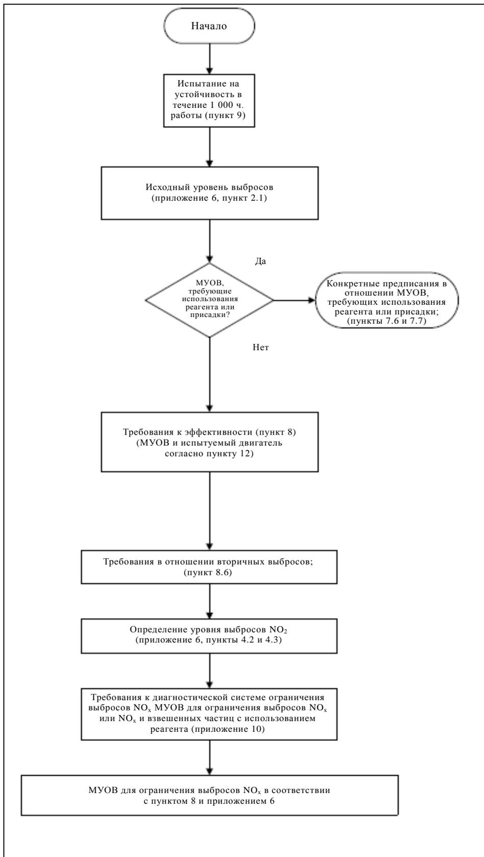
3. Последовательность испытания МУОВ для ограничения выбросов взвешенных частиц и NO<sub>x</sub>
