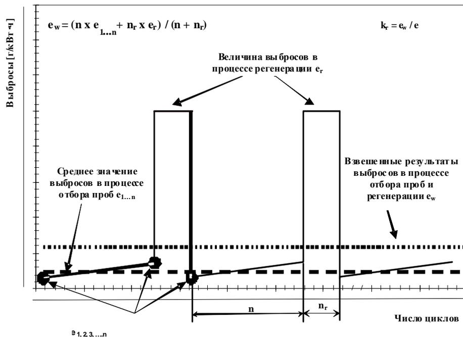
Выбросы в ходе испытания ВСПЦ в условиях запуска двигателя в прогретом состоянии взвешивают следующим образом:
