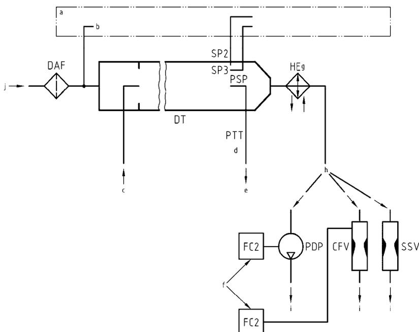
a = система анализатора; b = фоновый воздух; c = отработавшие газы;
