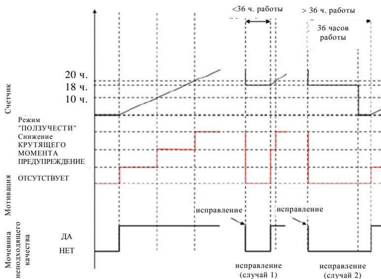
A.2.5.4 На рис. 4 показаны три случая неисправности системы дозирования мочевины. На этом же рисунке показан процесс, который применяется в случаях неисправностей системы мониторинга, описанных в разделе 9 настоящего приложения:
