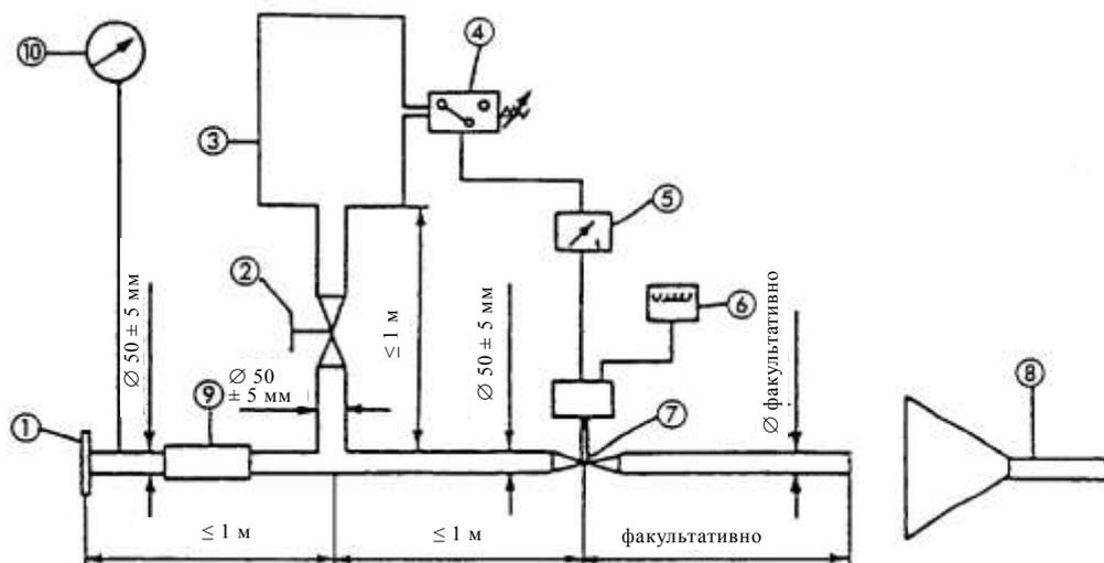
1. Впускной фланец или патрубок, подсоединяемый сзади к испытуемой системе глушителя выхлопа в сборе.
