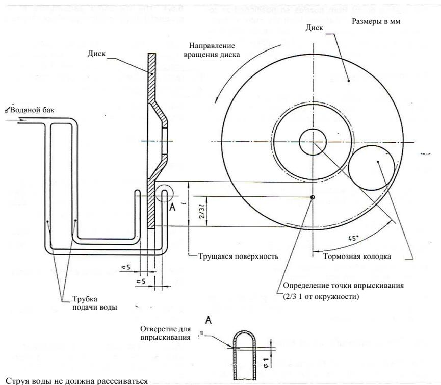
Оборудование для подачи воды на дисковый тормоз устанавливается следующим образом:
