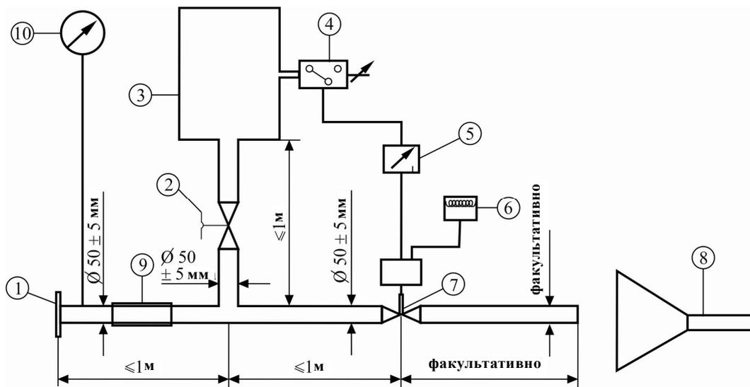
1. Впускной фланец или патрубок для подсоединения к задней части испытываемой выхлопной системы.
